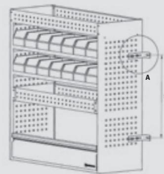
Abstand "A" variiert in Abhängigkeit zum Fahrzeug. Optimal ist eine zusätzliche Befestigung in der Bodenplatte möglich.
